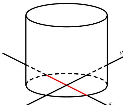
Por el eje  $x$  pasa el plano de corte y así, se obtiene la cuña. La ecuación de la circunferencia de la base es  $x^2 + y^2 = R^2$ .
